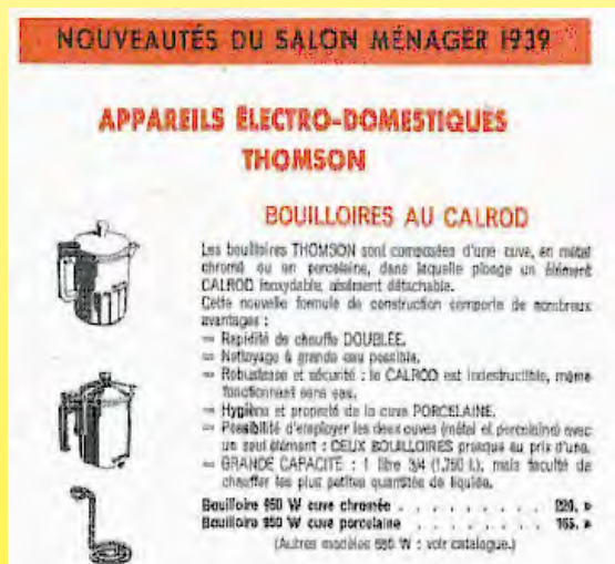
1939 อุปกรณ์ทำความร้อน Calrod ทำจากสแตนเลสสตีล (เอกสารสิทธิบัตร Ultimheat)
